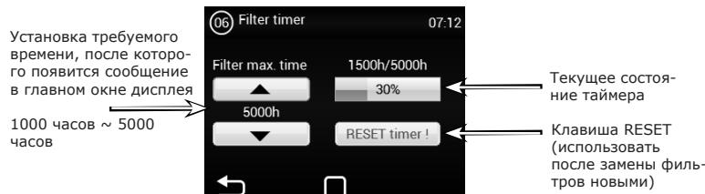
Пример отображения состояния забитого фильтра в главном окне
