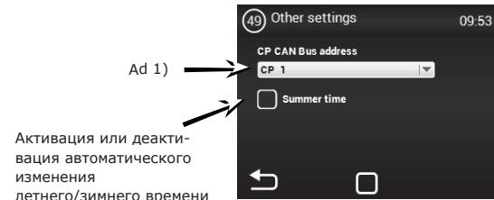
**Ad 1)** - Возможность установить адрес CAN панели управления так, чтобы можно было подключить к регулировке MASTER до 2 панелей управления
