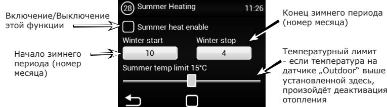
Если датчик внешней температуры не настроен, режим „summer heating“ работает только по выбранному времени, и установленная температура не годится
