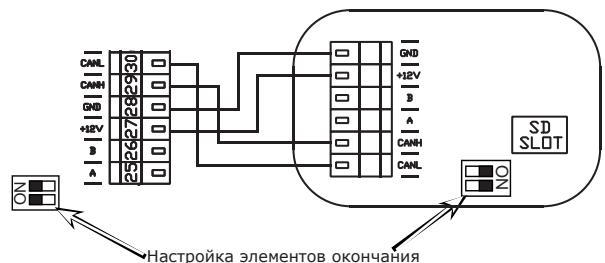
Пример включения устройств управления - Возможность 1:
