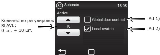
**Ad 1)** - Возможность использования одного дверного контакта как главного, состояния которого будет послано на регуляторы SLAVE. В этом случае отпадает необходимость включения дверного контакта в каждую регулировку, если такое требование есть.
