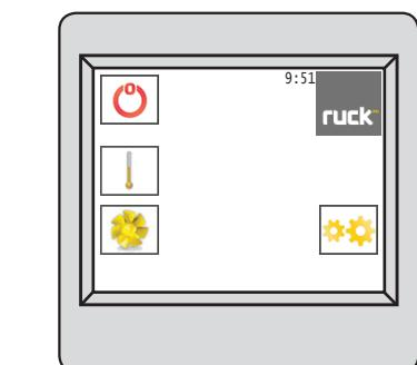
Пульт управления позволяет настраивать и активировать функции агрегата. В пульт управления встроен датчик, измеряющий температуру в помещении. На дисплее отображаются рабочие параметры и сообщения об отказах. С помощью кнопок пульта можно выбирать пункты меню и изменять параметры управления.
