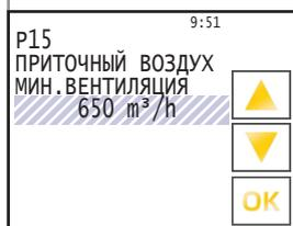
**P 15 мин. вентиляция – приточный воздух, P 16 мин. вентиляция – вытяжной воздух**
