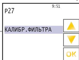
Перед проведением калибровки фильтра монтаж вентиляционной установки должен быть полностью завершен. Агрегат автоматически переходит в режим калибровки при нажатии кнопки «▲». На экране мигает сообщение «КАЛИБРОВКА ФИЛЬТРОВ».
