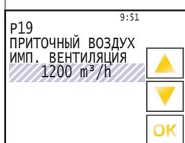
**P 19 импульсная вентиляция – приточный воздух, P 28 импульсная вентиляция – вытяжной воздух**
