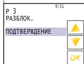
Агрегат можно включить только при условии, что контакт замкнут. Если контакт разомкнут, на дисплее отображается надпись «БЛОКИРОВКА». Контакт должен быть замкнут, после чего блокировка должна быть отменена нажатием кнопки «OK». По умолчанию действует настройка АВТОМАТИЧЕСКИ.
