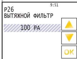
**P 26 Падение давления на фильтре удаляемого воздуха**
