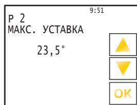
Ввод значения подтверждается нажатием кнопки. Затем возврат к экрану состояния производится с помощью кнопок «▲» и «▼» или «OK».
