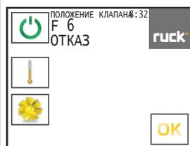
**Неисправность – положение заслонок**
