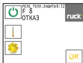
**Срабатывание реле тепловой защиты электронагревателя**
