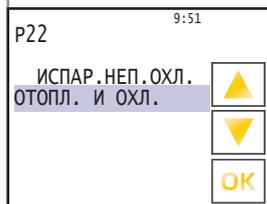
**P 22 нагревание и охлаждение (испаритель непосредственного охлаждения)**
