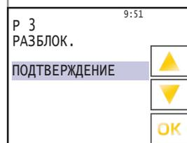
Агрегат можно включить только при условии, что контакт замкнут. Если контакт разомкнут, на дисплее отображается надпись «БЛОКИРОВКА». Контакт должен быть замкнут, после чего блокировка должна быть отменена нажатием кнопки «ОК». По умолчанию действует настройка АВТОМАТИЧЕСКИ.
