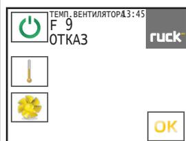
**Срабатывание встроенного термоконтakta вентилятора**
