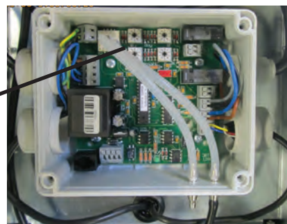
Рис. 4: Задание уставки дифференциального давления с помощью переключателей
